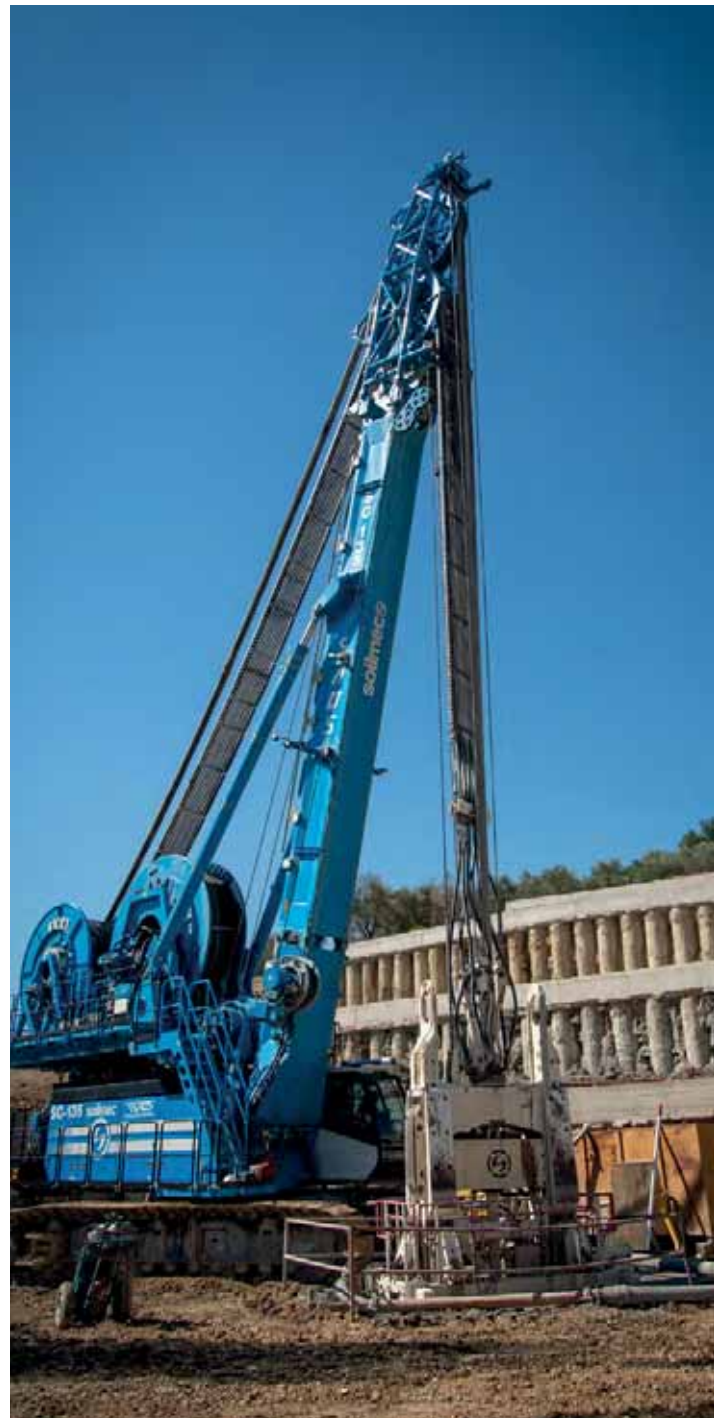
Idrofresa Soilmec, modello "Tiger" SC-135 | Melito Irpino, Italia
